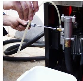
2 Den mit dem UNTERBRECHUNGSVENTIL verbundenen Schlauch in einen Behälter legen und das Ventil mit Hilfe eines Schraubenziehers öffnen.
