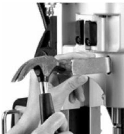
Abb. 17: Werkzeug lösen
