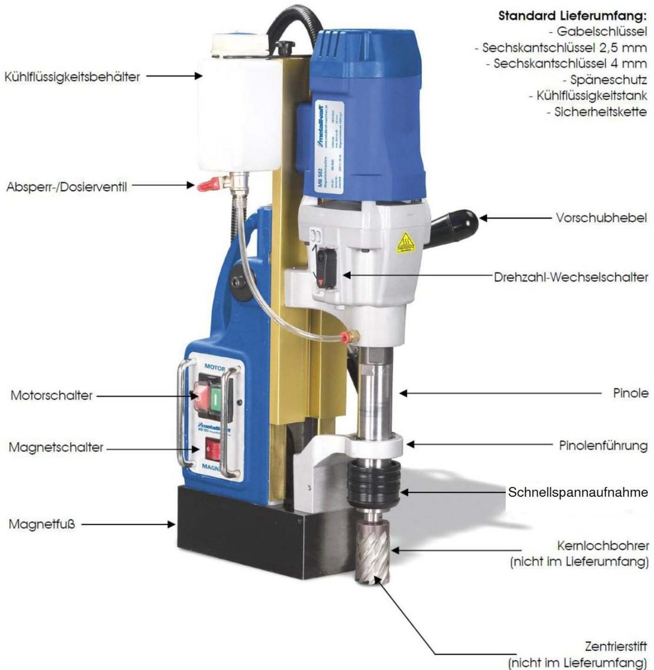
Abb. 5: Bedienelemente der Magnetbohrmaschine MB 502
