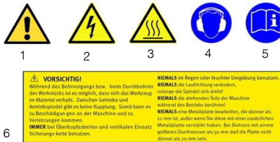
Abb. 1: Sicherheitskennzeichnungen - 1 Warnung vor Gefahren - 2 Warnung vor gefährlicher elektrischer Spannung - 3 Warnung vor heißen Oberflächen - 4 Gehörschutz tragen - 5 Betriebsanleitung beachten - 6 Sicherheitshinweise
