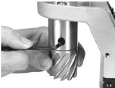
Abb. 12: Kernlochbohrer montieren
