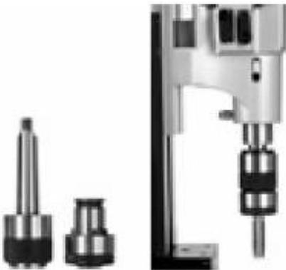
Abb. 21: Aufbau zum Gewindeschneiden
