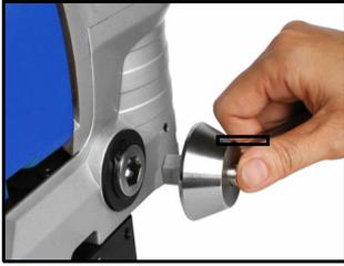
Der Vorschubhebel ist ein Schnellwechsler. Sie können diesen auf beiden Seiten der Magnetbohrmaschine anbringen, weshalb Ihnen ein individuelles Arbeiten ermöglicht wird.
