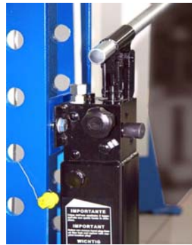
Abb. 11: Aufpumpen des Pumpendrucks
