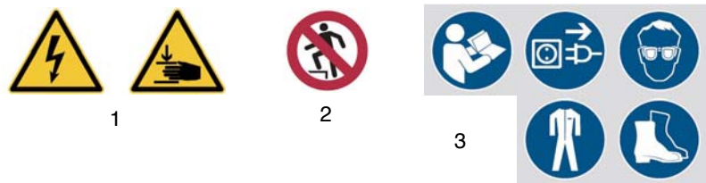
Abb. 1: Sicherheitskennzeichnungen - 1 Warnzeichen: Warnung vor gefährlicher elektrischer Spannung, Gefahr für Handverletzungen | 2 Verbotsszeichen: Nicht betreten | 3 Gebotszeichen: Betriebsanleitung lesen, Netzstecker ziehen, Augenschutz, Sicherheitskleidung, Sicherheitsschuhe tragen
