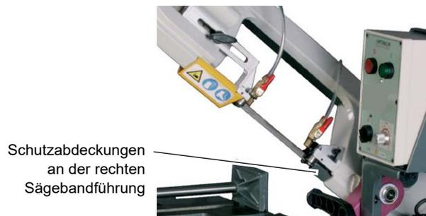
Abb. 1-3: Schutzabdeckung Sägebandführung
