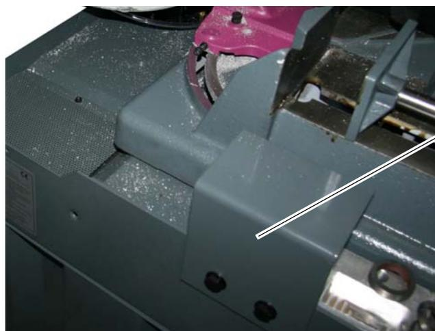
Abb.3-2: Montage Materialablage
