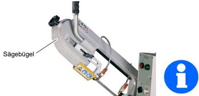
Abb. 1-2: Sägeblattgehäuse mit Schutzabdeckung
