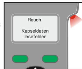
Kapsel beschädigt oder nicht korrekt eingesetzt.
