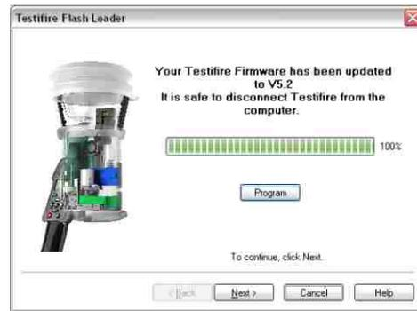
Im unwahrscheinlichen Fall, dass Programmierschritt misslingt oder der Nutzer den Programmierprozess unterbricht, bleibt das Testifire im Boot-Loader-Modus. Klicken Sie auf "Cancel", um das Programm zu verlassen. Trennen Sie dann das USB-Kabel und den Akku-Stab vom Testifire-Gerät. Der Programmiervorgang kann dann ab Schritt 1 wiederholt werden.
