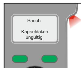
Kapsel beschädigt oder nicht korrekt eingesetzt.
