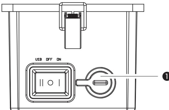
Aby włączyć oprawę oświetleniową, należy przełączyć przełącznik w pozycję "I" (ON). W celu wyłączenia należy przełączyć przełącznik w ustawienie środkowe "O" (OFF).
