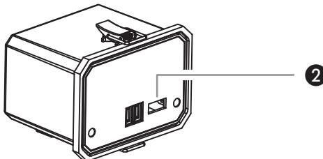
Piemērota produktiem ar maks. 1000 mA uzlādes strāvu. Lai uzlādētu ierīci, pievienojiet to ar USB uzlādes vadu akumulatora USB ligzda (skat. attēlu 2) un iestatiet slēdzi stāvoklī "II" (USB).
