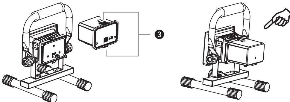
Akumulátor lze snadno a rychle vyměnit. Odblokujte k tomu nahoře a dolů oba uzávěry 3, viz výkres. Tak je např. možné, aby se nabíjel jeden akumulátor a současně se dále pracovalo se separátním náhradním akumulátorem.
