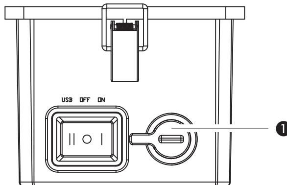
Para encender la lámpara, colocar el interruptor en posición "I" (ON). Para apagar el interruptor, colocar el interruptor en posición "O" (OFF).
