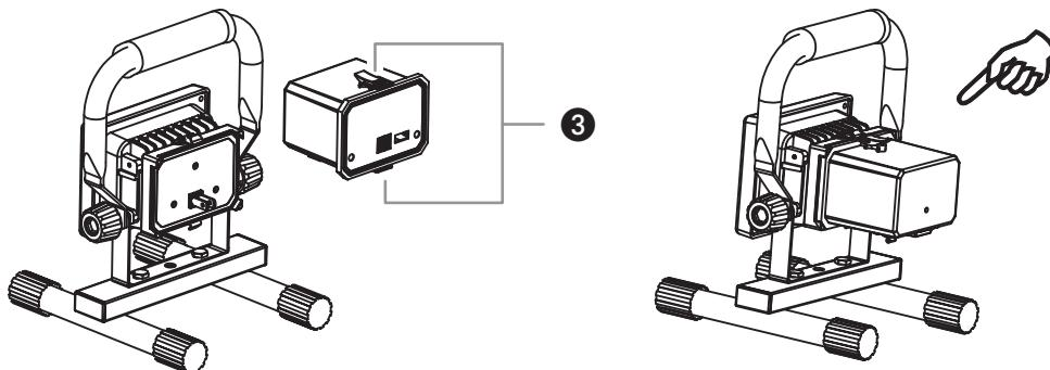
Batteriet kan snabbt och enkelt bytas ut. Lossa de båda låsen 3 ovan och under, se teckning. På så vis är det t.ex. möjligt att ladda upp ett batteri och samtidigt arbeta vidare med ett utbytesbatteri (köps separat).
