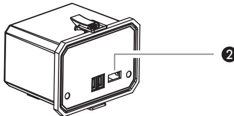
Geschikt voor producten met een laadstroom van max. 1000 mA. Om een apparaat op te laden, sluit u het met een USB-laadkabel aan op de USB-laadingang van de batterij (zie tekening 2) en zet u de schakelaar in stand "II" (USB).
