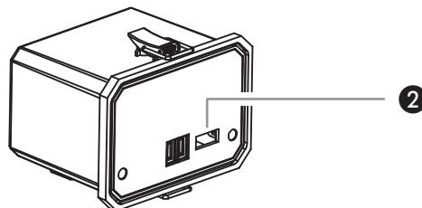
Apropiado para productos con una corriente de carga de máx. 1000 mA. Para cargar el dispositivo conectar el cable USB al puerto USB de carga de la batería (ver dibujo ②) y poner el interruptor en posición "II" (USB).
