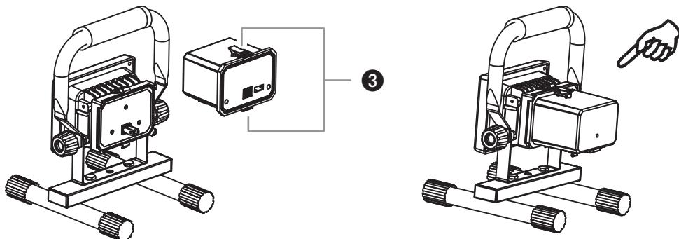
Akumulátor sa dá ľahko a rýchlo vymeniť. Odblokujte k tomu hore a dole oba uzávery 3, pozri výkres. Tak je napr. možné, aby sa nabíjal jeden akumulátor a súčasne sa ďalej pracovalo so separačným náhradným akumulátorom.
