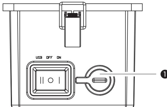
Zum Einschalten der Leuchte den Schalter in Position »I« (ON) bringen. Zum Ausschalten den Schalter in Mittelstellung »O« (OFF) bringen.
