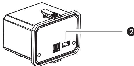
Adequado para produtos com uma corrente de carga de máx. 1000 mA. Para efetuar o carregamento ligue o aparelho a ser carregado através de um cabo USB à conexão de carregamento USB da bateria (ver figura 2) e coloque o interruptor na posição "II" (USB).
