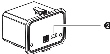
Primerno za izdelke z zmogljivostjo polnjenja največ 1000 mA. Za polnjenje je potrebno napravo, ki jo želite polniti, priključiti z USB polnilnim kablom na polnilni priključek USB na akumulatorju (glej risbo ②) in stikalo namestiti na položaj "II" (USB).
