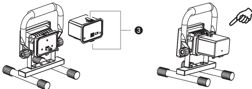
A bateria pode ser substituída de forma rápida e fácil. Para isso, deve debloquear os dois fechos 3 em cima e em baixo. Observe a figura. Deste modo é possível, por ex., carregar uma bateria e ao mesmo tempo continuar a trabalhar com uma bateria sobressalente disponível adicionalmente.
