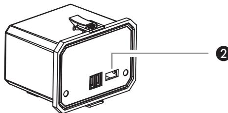
Soveltuu tuotteille, joiden latausvirta on maks. 1000 mA. Liitä ladattava laite USB-latauskaapelilla akun USB-latausliitintään (katso kuva 2) ja aseta kytkin asentoon "II" (USB).
