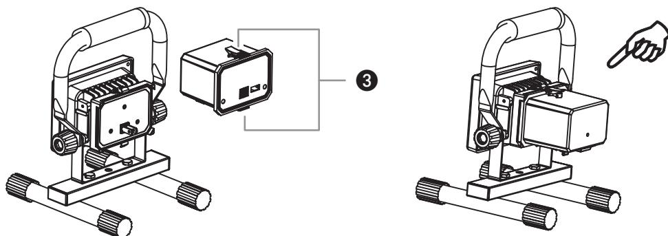
Der Akku kann einfach und schnell ausgetauscht werden. Dazu die beiden Verschlüsse ③ oben und unten entriegeln, siehe Zeichnung. Somit ist es z.B. möglich, einen Akku aufzuladen und gleichzeitig mit einem separat erhältlichen Ersatzakku weiter zu arbeiten.
