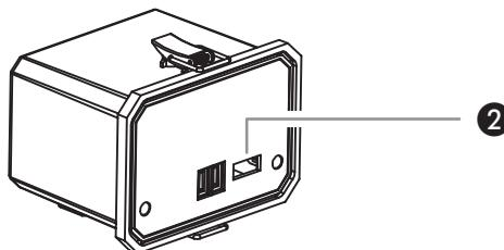
Azami 1000 mA şarj akımına sahip ürünler için uygundur. Şarj etmek için şarj edilecek cihazı USB şarj kablosu ile akünün USB şarj bağlantısına (bakınız Çizim ②) takın ve anahtarı "II" (USB) pozisyonuna getirin.
