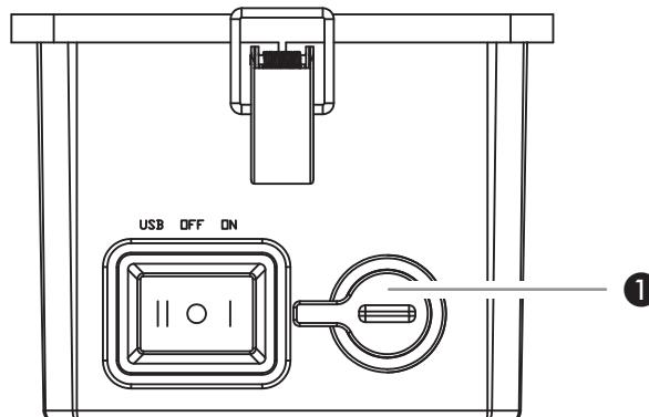
För att sätta på lampan, förs omkopplaren till läge "I" (ON). För att stänga av förs omkopplaren till mittenläget "O" (OFF).
