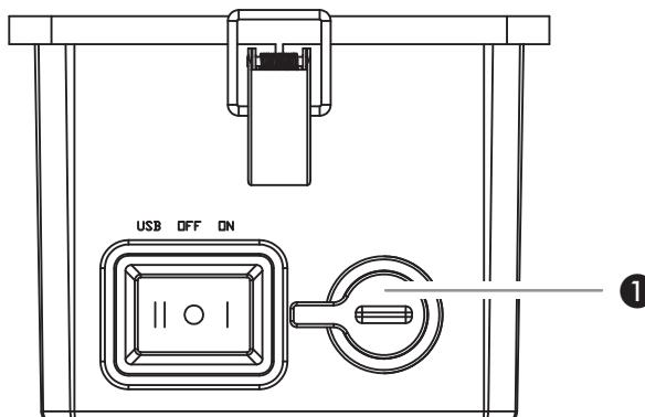
K zapnutí lampy přesuňte vypínač do polohy "I" (ON). K vypnutí přepněte vypínač do střední polohy "O" (OFF).
