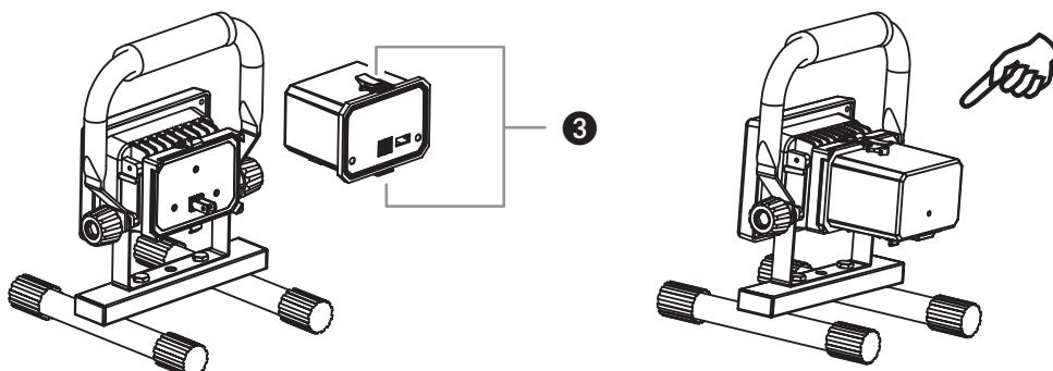
Akumulator można łatwo i szybko wymienić. W tym celu należy odblokować oba zamknięcia 3 u góry i na dole (patrz rysunek). Dzięki temu istnieje możliwość naładowania akumulatora i jednoczesnego kontynuowania pracy przy użyciu akumulatora zamiennego (do nabycia osobno).
