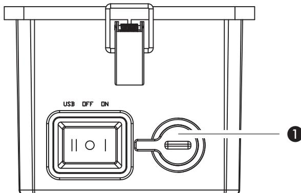
Na zapnutie lampy presuňte vypínač do polohy "I" (ON). Na vypnutie prepnite vypínač do strednej polohy "O" (OFF).
