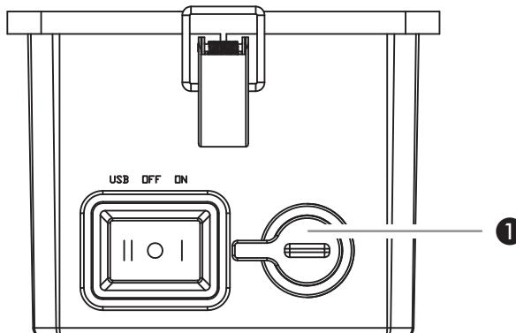
Lai ieslēgtu lampu, iestatiet slēdzi stāvoklī "I" (ON). Lai izslēgtu lampu, iestatiet slēdzi vidus stāvoklī "O" (OFF).
