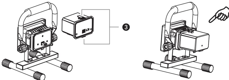
Замена аккумулятора производится быстро и просто. Для этого нужно отпустить оба зажима ③ (верхний и нижний), см. чертеж. В результате можно, например, зарядить аккумулятор и одновременно продолжать работать с использованием отдельно поставленного запасного аккумулятора.
