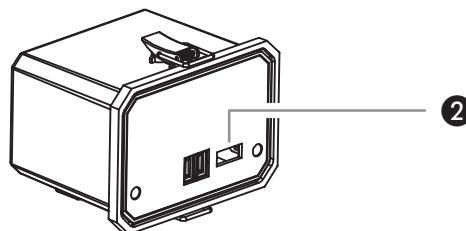
Idoneo per prodotti con una corrente di carica di massimo 1000 mA. Per eseguire la ricarica collegare l'apparecchio da caricare con un cavo di carica USB alla porta di carica USB della batteria (vedere illustrazione ②) e posizionare l'interruttore su "II" (USB).
