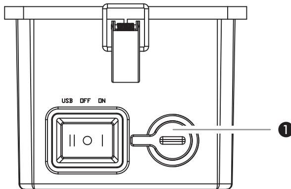
Para ligar o projetor coloque o interruptor na posição "I" (ON). Para desligar coloque o interruptor na posição do meio "O" (OFF).
