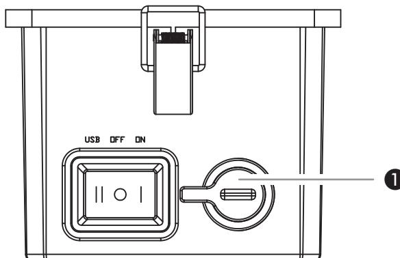
Kytke valaisin päälle asettamalla kytkin asentoon "I" (ON). Sammuta valaisin käänämällä kytkin keskiasentoon "O" (OFF).
