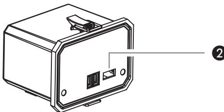
Κατάλληλο για προϊόντα με μέγιστο ρεύμα φόρτισης 1000 mA. Για τη φόρτιση συνδέστε την προς φόρτιση συσκευή μέσω ενός καλωδίου USB φόρτισης στη USB θύρα φόρτισης του συσσωρευτή (βλέπε σχήμα ②) και τοποθετήστε το διακόπτη στη θέση «II» (USB).
