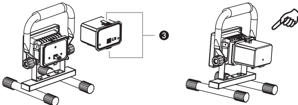
De batterij kan eenvoudig en snel worden vervangen. Ontgrendel daartoe de vergrendelingen 3 boven- en onderaan, zie tekening. Het is bv. mogelijk om een batterij op te laden en tegelijkertijd voort te werken met een aparte kopen vervangbatterij.
