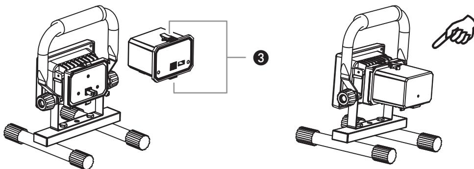
L'accumulateur peut être remplacé facilement et rapidement. Pour cela, déverrouiller les deux fermetures 3 en haut et en bas, voir dessin. Par exemple, il est ainsi possible de charger un accumulateur et de continuer à travailler simultanément avec un accumulateur de rechange disponible séparément.
