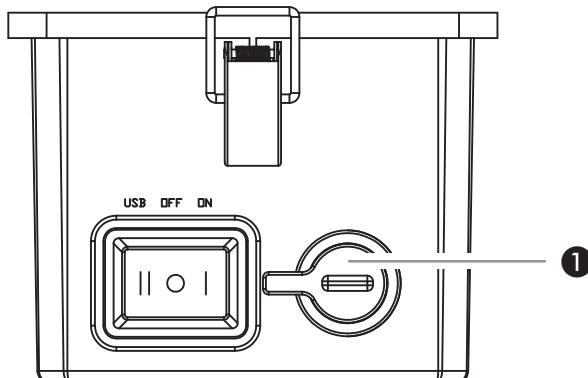
Om de lamp in te schakelen, zet u de schakelaar in de stand "I" (ON). Om de lamp uit te schakelen, zet u de schakelaar in de middelste stand "O" (OFF).
