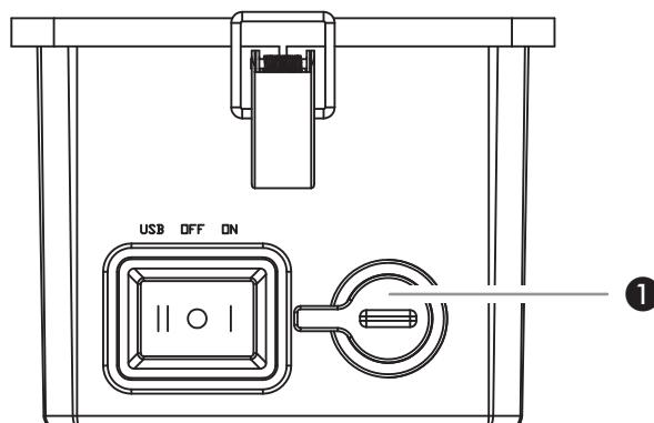
Для включения светильника выключатель нужно перевести в положение «I» (ON/ВКЛ.). Для выключения светильника выключатель нужно перевести в среднее положение «O» (OFF/ВЫКЛ.).
