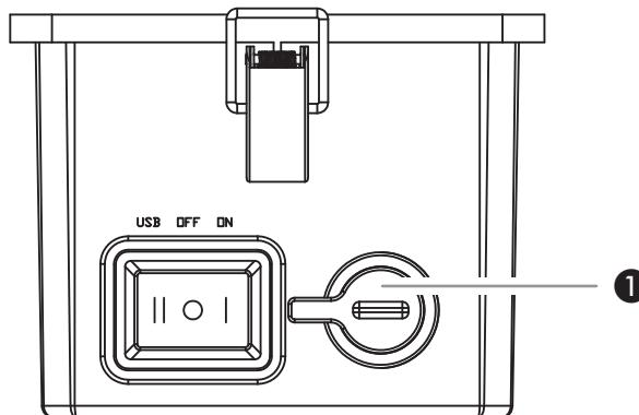
Pour allumer la lampe, mettre le bouton sur la position « I » (ON). Pour éteindre, mettre le bouton sur la position centrale « O » (OFF).
