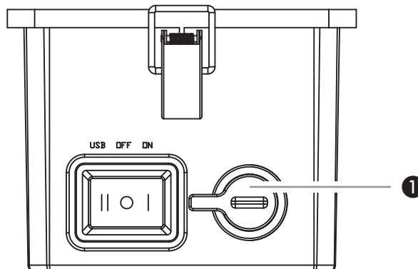
Za vklop reflektorja naj bo stikalo nastavljeno na položaj "I" (VKLOP). Za izklop mora biti stikalo na položaju "O" (IZKLOP).
