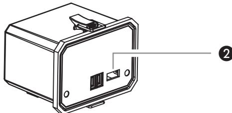
Заряжать можно приборы, рассчитанные на ток зарядки максимум в 1000 мА. Для выполнения зарядки заряжаемый прибор нужно с помощью зарядного кабеля под USB-порт подключить к зарядному USB-гнезду на аккумуляторе (см. чертеж ②) и перевести выключатель в положение «II» (USB).
