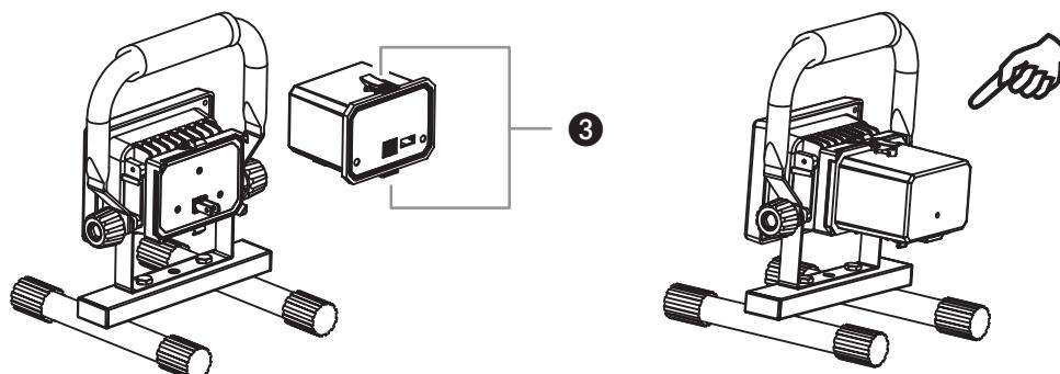
La batteria può essere sostituita in modo semplice e veloce. Per farlo, sbloccare entrambe le chiusure ③ sopra e sotto, vedere illustrazione. In tal modo è possibile, p.es., caricare una batteria e al contempo continuare a lavorare con una batteria di ricambio fornibile separatamente.
