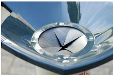
Das Häckselmaterial muss durch die Öffnung in der Mitte des Fülltrichters geschoben werden. Lange Äste sollten vorab gekürzt werden.
