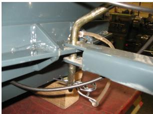
Ziehen Sie den Easy Worker an die HVR plus heran und führen den Stecker mit Kette (bzw. Sicherungsband) durch die Deichsel und der Anhängerkupplung. Stecken Sie den Federstecker durch die Bohrung des Stecker mit Kette (bzw. Sicherungsband) bis dieser einrastet.
