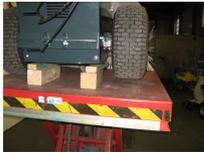
Zuerst müssen Sie HVR plus aufbocken, so dass die Reifen in der Luft hängen.
