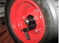
Nun platzieren Sie den Mitnehmer auf der linken Seite. Danach die Mitnehmerscheibe und den Sicherungsring auf der linken und rechten Seite. Stecken Sie jetzt noch die schwarze Schutzkappe links und rechts auf die Radnaben.
