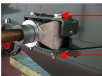
Nehmen Sie die Sechskantschrauben M8x75 und eine Unterlegscheibe  $\varnothing 8,4$  und führen Sie diese von oben durch die Bohrung.
