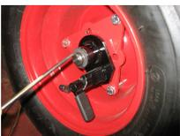
Demontieren Sie nun den Sicherungsring, links und rechts mit einem Schlitzschraubenzieher.
