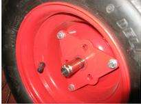
Auf der linken Seite müssen Sie zuerst den Reifen auf der Antriebswelle platzieren und dann die Passfeder montieren.
