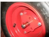
Demontieren Sie die Passfeder, auf der linken Seite und ziehen Sie die Reifen links von der Antriebswelle. Die Passfeder auf der rechten Seite kann in der Antriebswelle montiert bleiben, Sie müssen nur den Reifen abziehen.
