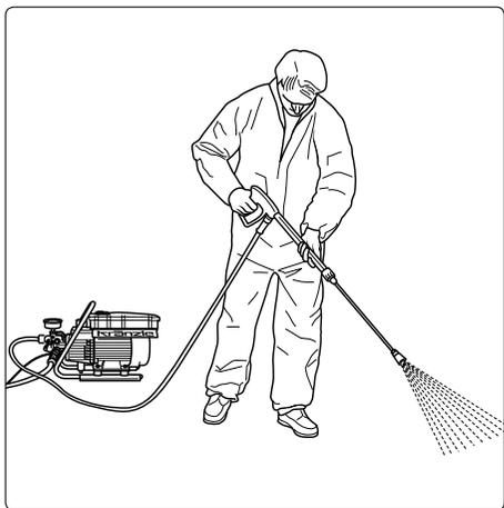
**12.** Gerät bei **geöffneter** Spritzpistole einschalten. Gerät entlüften: Pistole mehrmals öffnen und schließen. Mit dem Waschvorgang beginnen.
