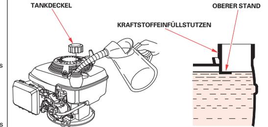
3. Beim Auftanken vorsichtig vorgehen, um Verschütten von Kraftstoff zu vermeiden. Den Kraftstofftank nicht überfüllen (im Kraftstoffeinfüllstutzen soll kein Kraftstoff sein). Je nach Betriebsbedingungen muss der Kraftstoffstand eventuell gesenkt werden. Nach dem Tanken den Tankdeckel wieder gut andrehen.
