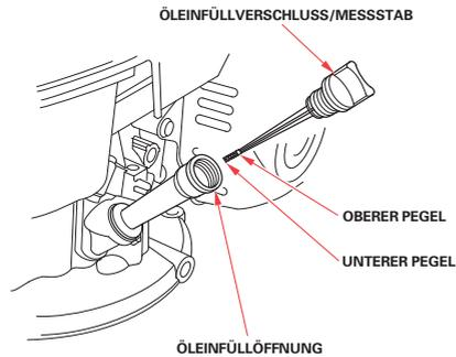
4. Den Öleinfüllverschluss/Messstab anbringen.
