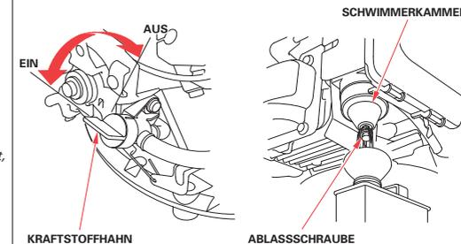
5. Wenn Ablassen vom Vergaser nicht möglich ist, den Kraftstofftank mithilfe einer im Handel erhältlichen Handpumpe in einen für Benzin zugelassenen Behälter entleeren. Vom Gebrauch einer Elektropumpe wird abgeraten. Den Motor so lange laufen lassen, bis er wegen Kraftstoffmangels stehen bleibt.
