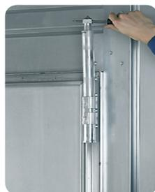
oder die vorhandene Durchbohrung Ø 6 mm nutzen, z.B. mit einem Stahlstift, Rundeisen oder Inbusschlüssel.
