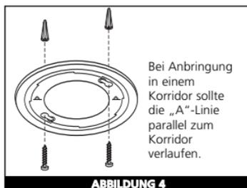
1. Für eine ästhetische Ausrichtung des Melders am Montageort kann die "A"-Linie auf dem Montageteller genutzt werden. Diese erleichtert eine Ausrichtung z.B. parallel zum Verlauf eines Ganges oder Flures.
