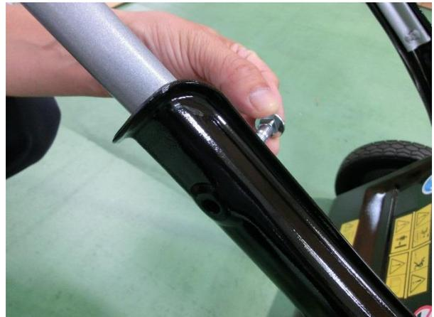
Montieren Sie die Unterlegscheibe, den Federring und die Hutmutter wie in der Abbildung gezeigt.
