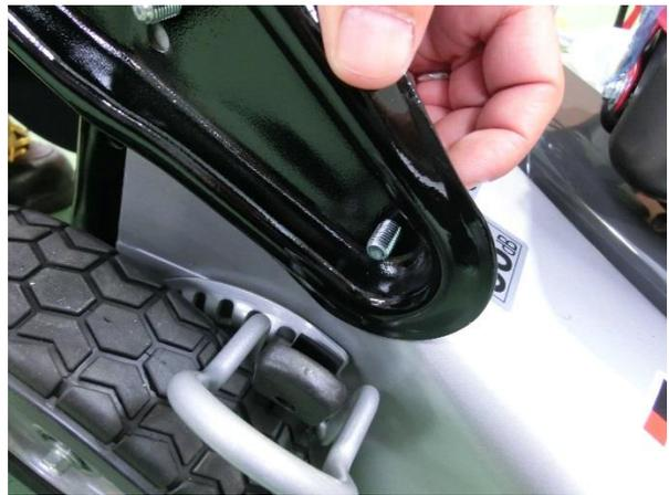
10) Montieren Sie die Unterlegscheibe, den Federring und die Hutmutter wie in der Abbildung gezeigt.
