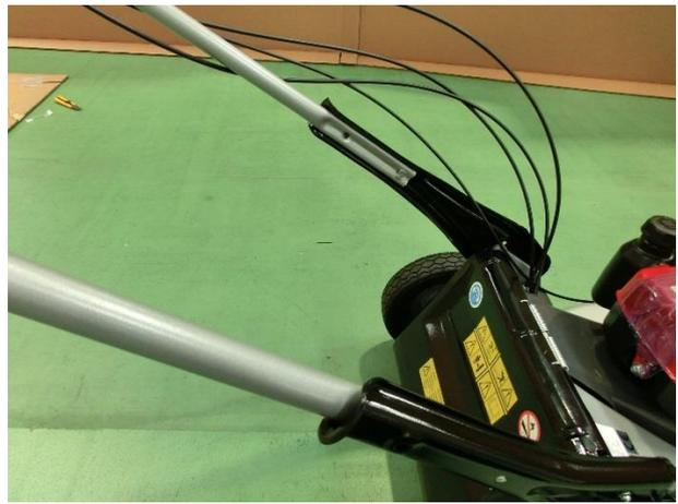
14) Montieren Sie die Schlossschraube M8x35 von der Innenseite.
