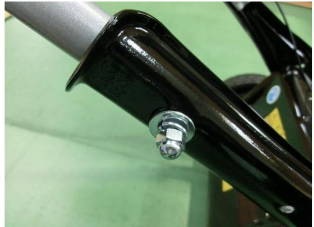
15) Montieren Sie die Abstandshalter wie in der Abbildung gezeigt mit den zwei geschweißten M6x10 Schrauben von der Innenseite.
