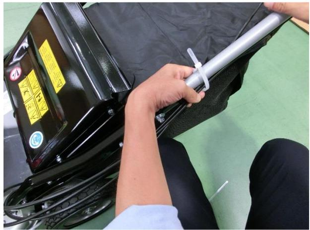
29) Sichern Sie die Bowdenzüge oberhalb der Getriebeabdeckung.
