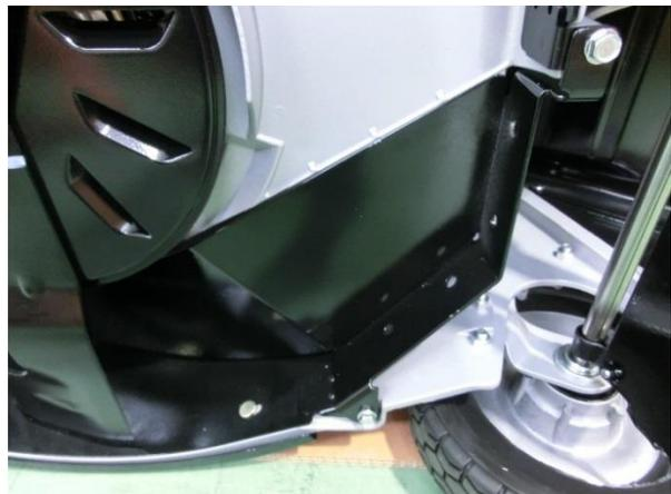
34) Montieren Sie das zusätzliche Mulchmesser
