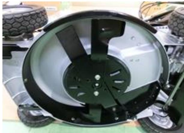
35) Montieren Sie die Mulchplatte wie in der Abbildung gezeigt.
