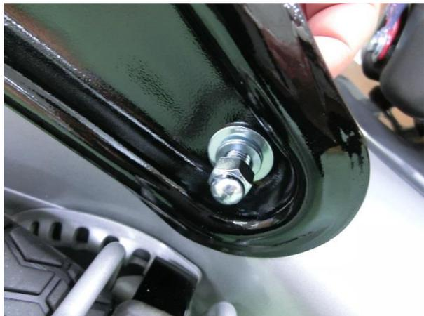
11) Montieren Sie die Unterlegscheibe, den Federring und die Hutmutter wie in der Abbildung gezeigt.
