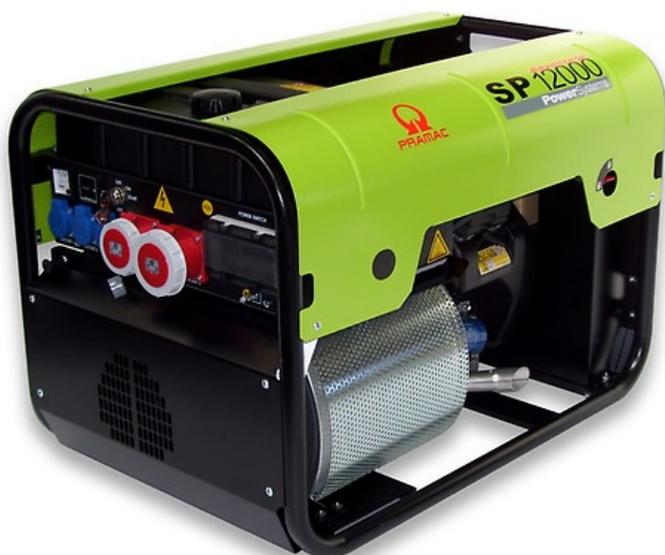
Dieser Stromerzeuger erfüllt die höchsten Ansprüche hinsichtlich Personenschutz (Isolationsüberwachung), Geräteschutz (Schutzklasse IP 54), Anlaufstromverhalten (elektronisch geregelter Synchrongenerator 4-fach I-Nenn) und Schiefasttauglichkeit (unterschiedliche Belastung der einzelnen Phasen).
