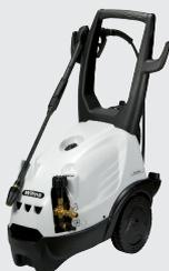
**KW 900:** Kaltwasser-HDR für Drehstrom. **Langsam laufende** Dreikolbenpumpe mit Keramikplungern und Messingkopf. Starkes Profigerät in fahrbarer Ausführung. Stufenlose Druckverstellung von außen zugänglich. Wasserzulauftemperatur bis max. 50° C. Reinigungsmitteltank im Chassis integriert. Komplett mit zweiteiliger Lanze mit Variodüse und Pistole, 10 m Hochdruckschlauch, Kabel mit 5-pol. CEE-Stecker, 16 Amp.
