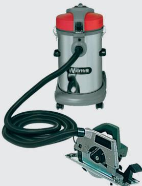
**WS 2650 AS:** Naß- und Trockensauger mit Schaltautomatik zur Staubabsaugung an Elektrowerkzeugen bis 2.000 Watt. Zusätzliche Schaltstellung für normales Saugen. Saugschlauch 5,5 m lang und mit 2 Adaptern für Elektrowerkzeuge. Sonderzubehör: Feinmedien-Membran-Dauerfilter für Kategorie M (Bestell-Nr. 5923063). Standard-Papierfilter, 10er-Packung (Bestell-Nr. 5923090).
