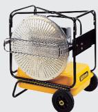
Vertikal ausrichtbarer Strahlungsheizer zur gezielten Punktbeheizung. Kein Warmluftgebläse, daher zur wirtschaftlichen Material- und Arbeitsplatzbeheizung im Freien und in großen, hohen Räumen mit guter Belüftung bestens geeignet. Elektro-Anschluß: 230 V, 50 Hz. Ölvorwärmung serienmäßig. Sonderzubehör: Raumthermostat.
