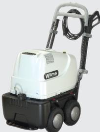
**HW 1100:** Unser »Leichtgewicht« für Wechselstrom. Dreikolbenpumpe mit Keramikplungern. Für einfache gewerbliche Ansprüche. Startet ohne Anlaufstrombegrenzer an allen üblichen, mit 16 Amp. abgesicherten Schuko Steckdosen. Durch Tragbügel und Ballonreifen leicht verfahrbar und gut zu transportieren. Heizöl- und Reinigungsmittel tanks serienmäßig. Komplett mit zweiteiliger Lanze, Variodüse und Pistole, 8 m Hochdruckschlauch, Kabel und Schuko-stecker.
