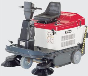
**KS 1300:** Aufsitz-Kehrmaschine für mittelgroße Flächen. Serienmäßig 2 Seitenbesen, Saugabschaltung, Grobschmutzklappe, Feststellbremse, Beleuchtung, Lift- und Kippvorrichtung, elektr. Filterrüttler. Mit 4 kW-Viertakt-Honda-Motor (bleifrei) mit Elektrostart, für max. 20 % Steigung. Das Überkopf-Kehrprinzip bewirkt eine hohe Ausnutzung des Behältervolumens.
