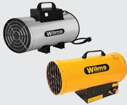
Flüssiggas-Heißluftgebläse in robuster Doppelmantel-Ausführung, anschlussfertig mit Schlauch, Gasdruckregler und Schlauchbruchsicherung. Alle Typen mit Tragegriffen. Elektro-Anschluß: 230 V, 50 Hz. Sonderzubehör: Mehrflaschenanschluß.
