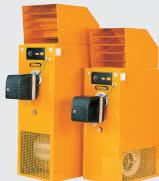
Ölbeheizte, vollautomatische Warmluftherzeuger in stationärer Ausführung mit Wärmetauscher und hohem Wirkungsgrad. Zum Beheizen und Belüften von Werkstätten, Produktions- und Lagerräumen etc. Auch zur liegenden Montage auf Wandkonsolen geeignet. Komplettgerät mit Ölbrenner und eingebautem Raumthermostaten. Ausblashaube mit Richtungslamellen rundum drehbar. Elektro-Anschluß: 230 V, 50 Hz. Sonderzubehör: 990 l-Tank. Sonderausführungen für Erdgas- oder Flüssiggas auf Anfrage.
