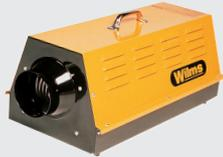
Elektro-Heißluftgebläse zum Heizen und Lüften. Robustes, baustellengerechtes Stahlblechgehäuse mit Tragegriff, Typ EL 15 zusätzlich mit Rädern. Neuartige Bauart mit Radialgebläse für hohen Luftdurchsatz bei hoher Pressung, auch mit Warmluftschlauch betreibbar. Mit Überhitzungsschutz und eingebautem Raumthermostaten. Sonderzubehör: Warmluftschlauch.
