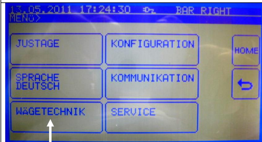
Anschließend die Taste "Wägetechnik" auslösen.
