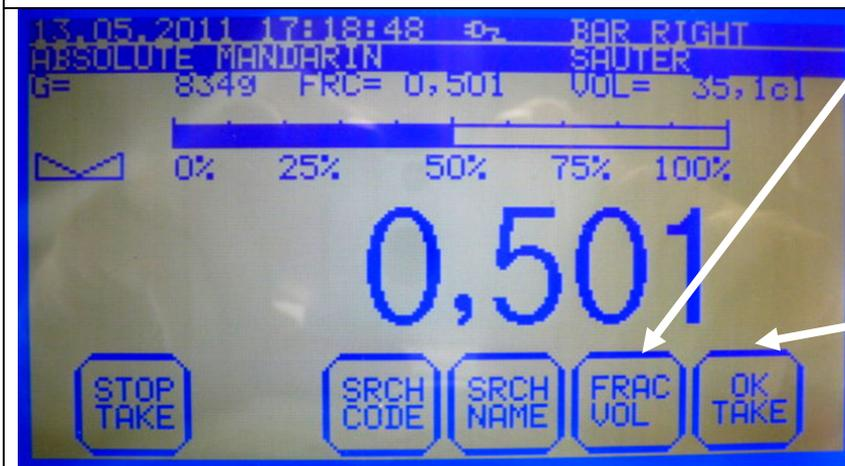
Durch Drücken der FRAC/VOL-Taste wird der Inhalt anteilig angezeigt.
