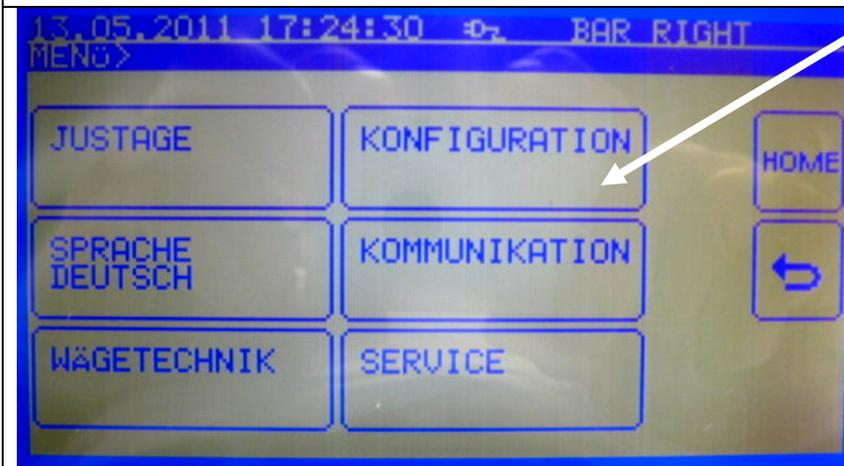
Soll die automatische Registrierung aktiviert werden, die Taste "Konfiguration" drücken.
