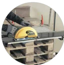
Ideal für Gitterroste mit LBS-Sägeblatt
