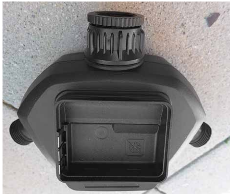
Der Water Controller: Anschluss für den Wasserhahn (oben), die Ventile (links / rechts), die Steuereinheit (Mitte) fehlt
