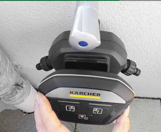
Die Steuereinheit des Controllers wird mit vier AAA-Batterien betrieben
