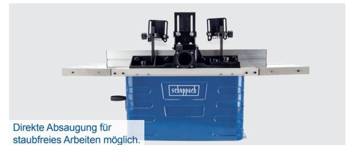
Direkte Absaugung für staubfreies Arbeiten möglich.
