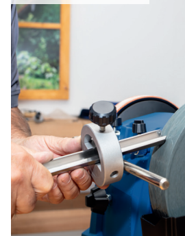
Schleift schräge Schneiden, Röhren und Hohleisen.
