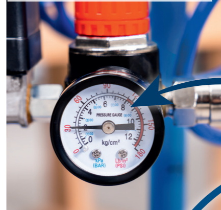
Mittels des Druckmanometers kann der Kesseldruck jederzeit abgelesen werden.
