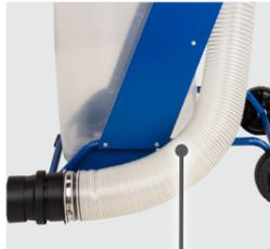
2 m Absaugschlauch
